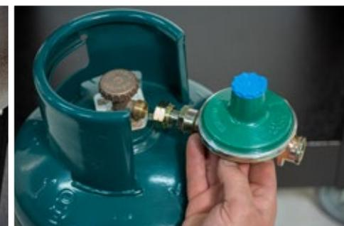
**2.** Vissez le détendeur de gaz dans le robinet de la bouteille et tournez le boulon dans le sens anti-horaire. Utilisez la clé pour le serrage du détendeur pour ne pas endommager le joint et donc l'étanchéité.
