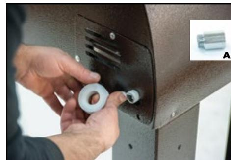
**1.** Isolez l'arrivée de gaz avec du téflon et vissez le connecteur (A).
