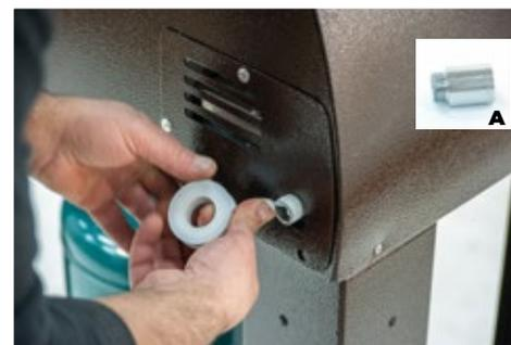
**1.** Isolez l'arrivée de gaz avec du téflon et vissez le connecteur (A).
