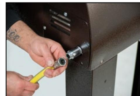
**4.** Vissez le tuyau au four et serrez avec la clé.
